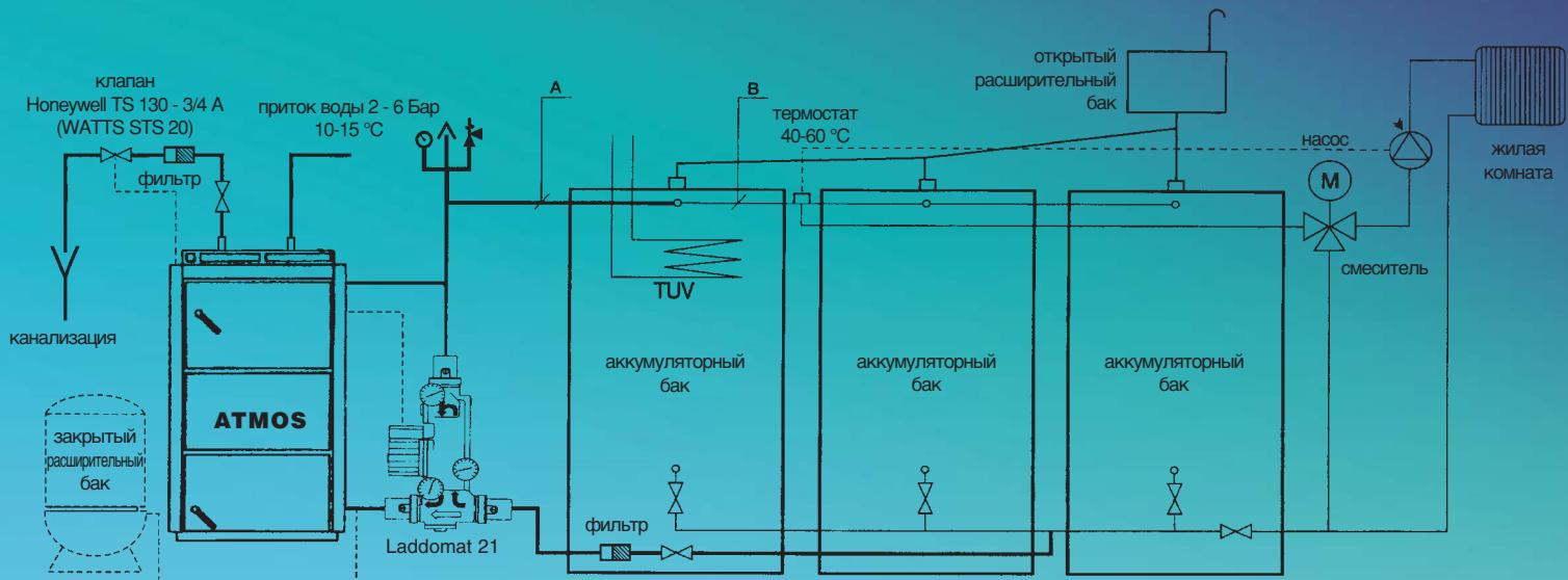
**Максимальной эффективности работы котла, увеличения его срока службы и соблюдения всех экологических параметров выхлопа, можно достичь при использовании аккумуляторных баков, когда котел работает на максимальной мощности.**
